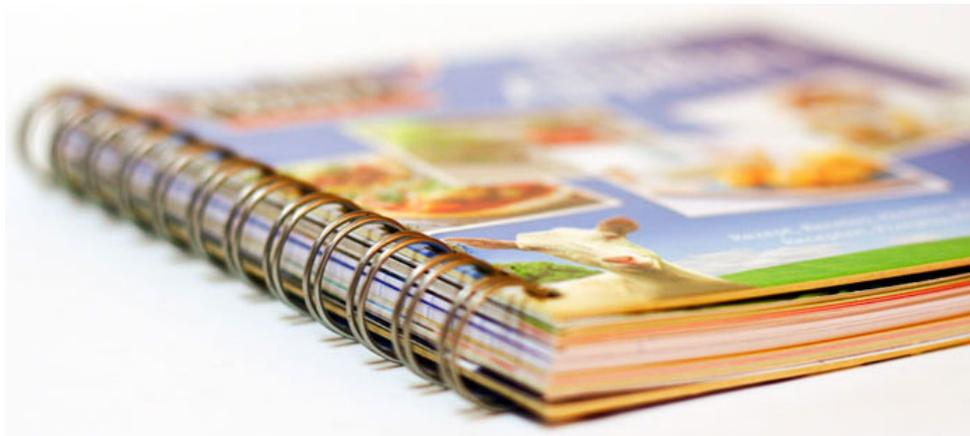
El sistema wire-o es un tipo de encuadernación basado en la unión de hojas mediante un hilo de alambre que forma anillas dobles y que en el momento de realizar la encuadernación se introduce en las perforaciones previamente realizadas, cerrándose a continuación.
