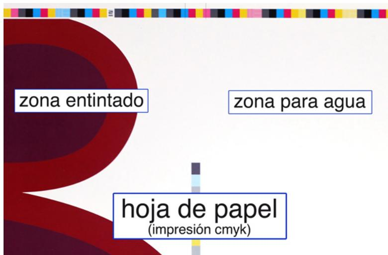
ta en una plancha revelada, así como las zonas hidrófilas (zona para agua) y las zonas lipófilas (zona de entintado).
